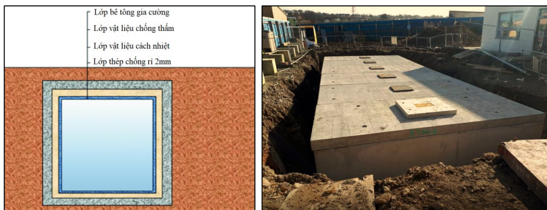
Hình 2.17 Cấu tạo hồ ngầm bê tông cốt thép
