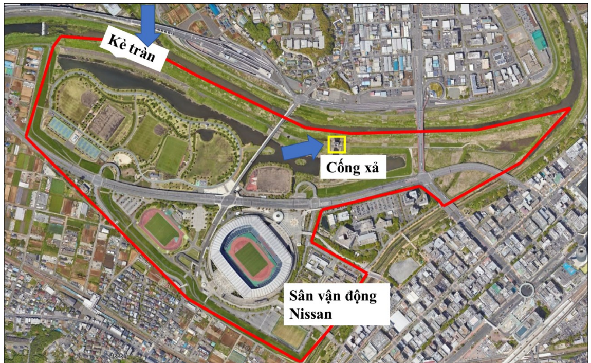
Hình 2.33 Hệ thống trữ lũ khu vực trung tâm thể thao Yokohama
