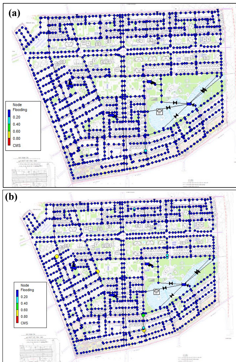
Hình 6.9 Kết quả vị trí ngập hồ ga nhiều nhất khu dân cư ĐTL khi có giải pháp công trình trữ: (a) (KB-A); và (b) (KB-C)
