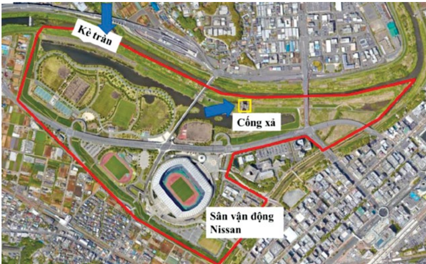
Hình 2.23 Nước lũ đi theo hệ thống kè tràn để vào khu trung tâm thể thao và được trữ, làm chậm
