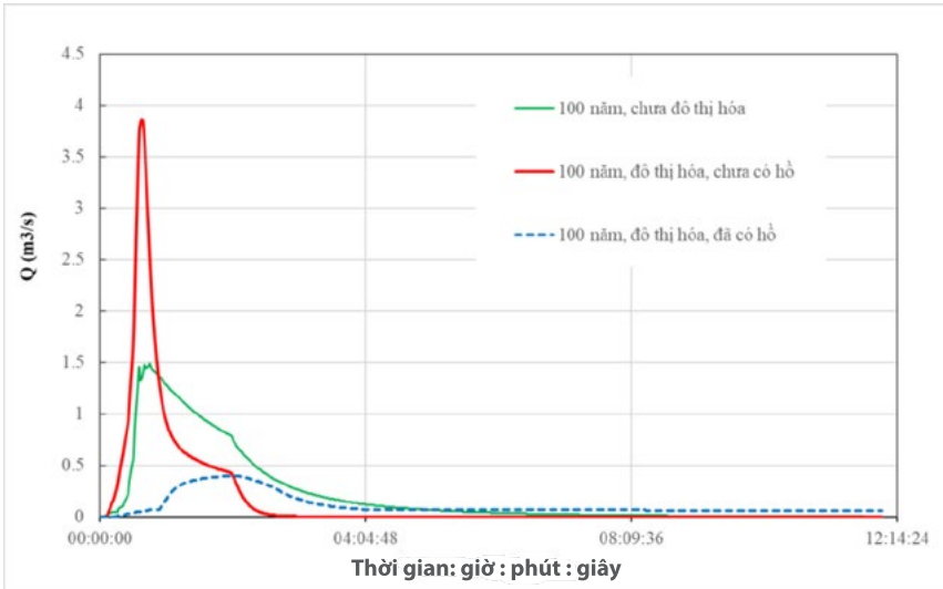
Hình 5.41 Đồ thị dòng chảy tràn tại cửa ra ứng với trận mưa thiết kế có chu kỳ lặp lại 100 năm
