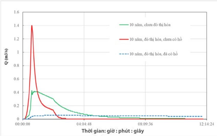
Hình 5.40 Đồ thị dòng chảy tràn tại cửa ra ứng với trận mưa thiết kế có chu kỳ lặp lại 10 năm
