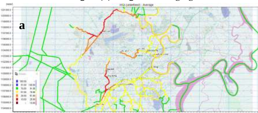
Hình PL3.13. Bản đồ phân vùng chất lượng nước kém nhất tháng 6/2021 khi có (a) và không có (b) công trình cống ngăn triều.
