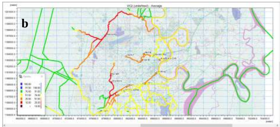
Hình PL3.11. Bản đồ phân vùng chất lượng nước trung bình tháng 5/2021 khi có (a) và không có (b) công trình cống ngăn triều.
