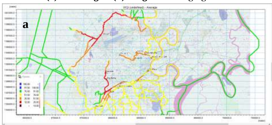
Hình PL3.4. Bản đồ phân vùng chất lượng nước kém nhất tháng 2/2021 2021 khi có (a) và không có (b) công trình công ngăn triều.
