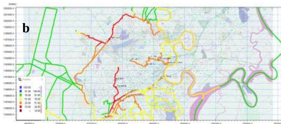
Hình PL3.13. Bản đồ phân vùng chất lượng nước kém nhất tháng 6/2021 khi có (a) và không có (b) công trình cống ngăn triều.
